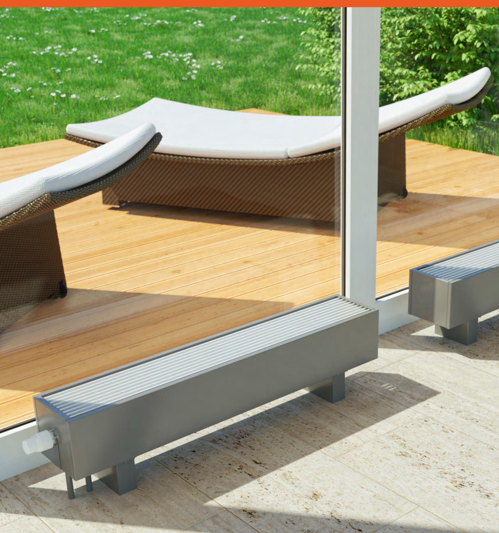
Естественная конвекция – это способ выделения тепла в пространство за счет теплообменника, состоящего из медных труб и алюминиевых ламелей. Поток горячей воды нагревает трубу, после чего воздух между ламелями, начинает подниматься вверх благодаря так называемому эффекту дымохода.
